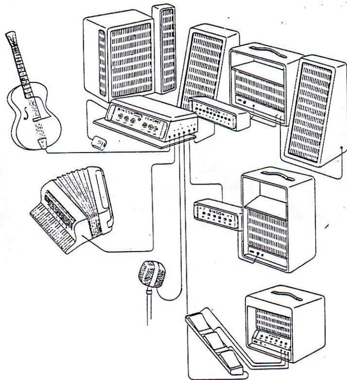
Schema di collegamento dell'apparecchio ECHOREC usando l'impianto BINSON completo della serie MN.
