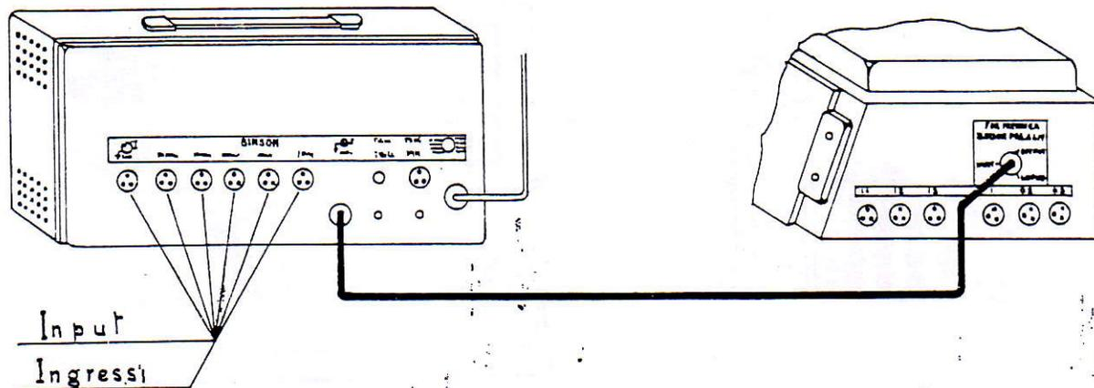
Tutti i tasti del selettore canali (23) devono stare in posizione disinserita, cioè non presati. Questo collegamento permette di ottenere il massimo rendimento degli effetti generati dall'Echorec Binson. In questo caso le 3 prese d'ingresso (27) e d'uscita (28) non devono essere collegate con altri strumenti o miscelatori.
